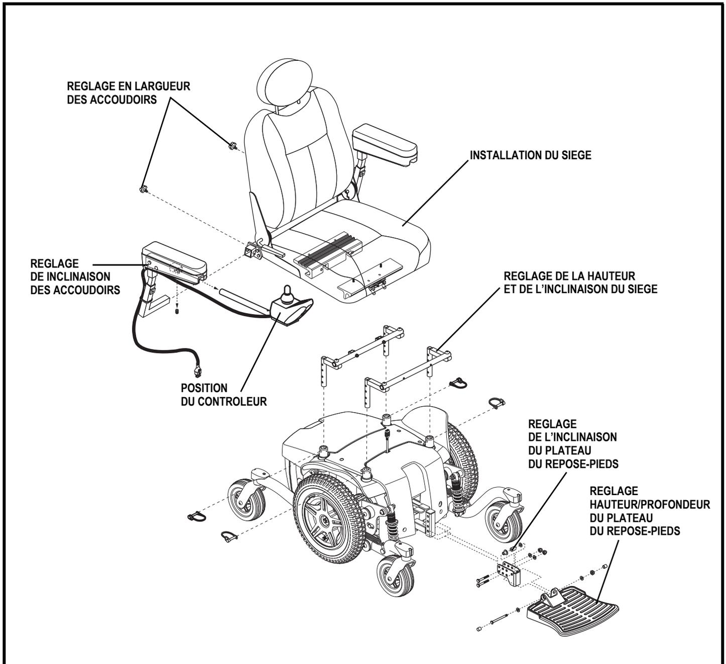
Figure 10. Vue de l'assemblage du fauteuil Jazzy 614 Serie (Système de siège standard montré)
